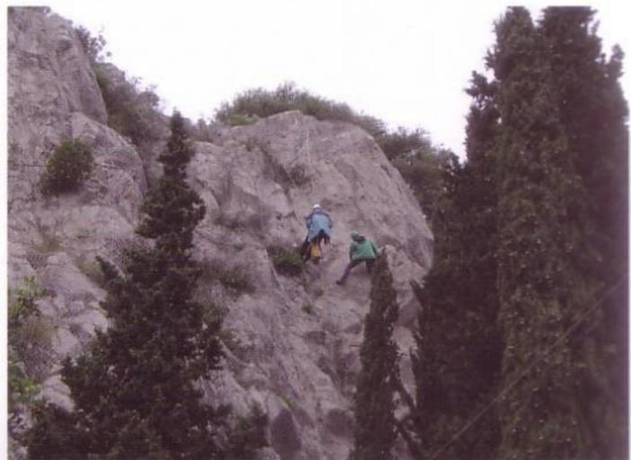
**Foto 13** - Rilievi geostrutturali eseguiti con metodi alpinistici
